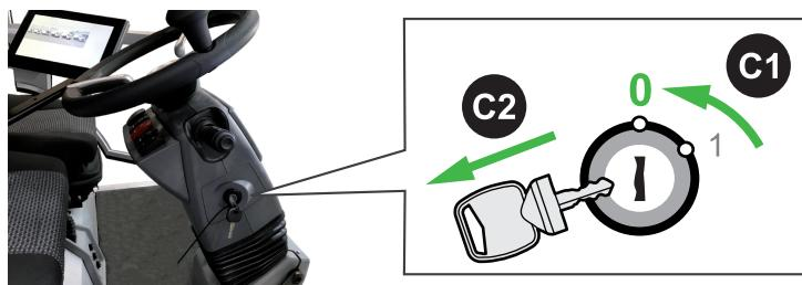
Isolation de la tension en coupant le „contact“ (C1). Retirez la clé (C2) et gardez-la en sécurité.
