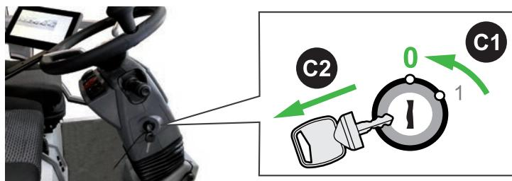
Isolation de la tension en coupant le „contact“ (C1).
