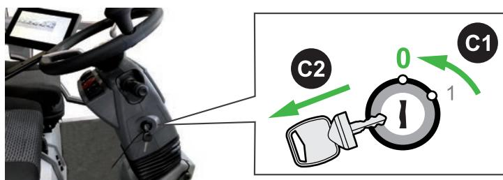
Desconecte la tensión apagando el «encendido» (C1). Extraiga la llave (C2) y guárdela en un lugar seguro.
