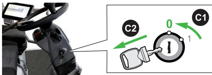
Spannungsfreischaltung durch Abschalten der „Zündung“ (**C1**). Schlüssel abziehen (**C2**) und sicher verwahren.
