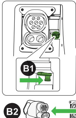
Ouvrir le clapet latéral vdroit du bac à déchets. Pour le déverrouillage de secours, déplacer sur la droite le levier (B1) situé derrière la prise.
