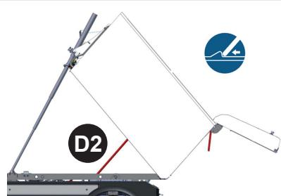
Bis zur vollen Entladestellung anheben und Stütze einrasten lassen (D2).
