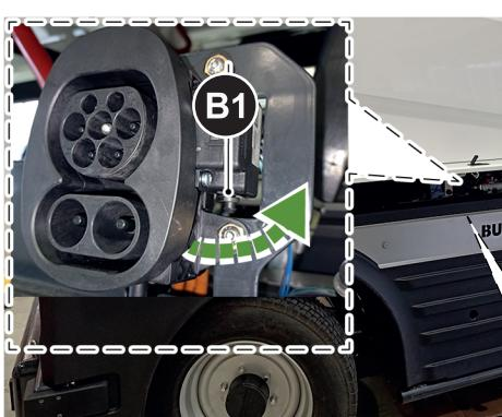
Seitenklappe öffnen (B1). Für die Notentriegelung den Hebel (B2) hinter der Steckdose nach rechts bewegen.
