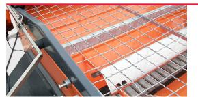
Cubierta de cierre de PVC y rejilla de protección Cubierta de PVC practicable desde el suelo, con bastidor de acero inoxidable AISI 304, debajo del cual se encuentra una rejilla de protección zincada de malla 80 x 80 mm.
