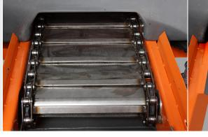
Cinta transportadora metálica Constituida por una cinta metálica con listones de acero inoxidable AISI 304.
