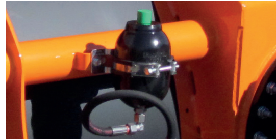
Stickstoff-Druckspeicher Dienen als Ausweicheinrichtung bei Verwendung der Stahlräumleiste.
