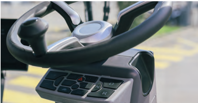
Pannello di comando sul piantone dello sterzo Il pannello di comando contiene tutti i pulsanti importanti per la guida, facilmente e rapidamente accessibili.
