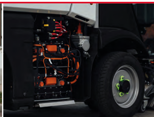
Bloc-batterie Bucher 55 kWh
