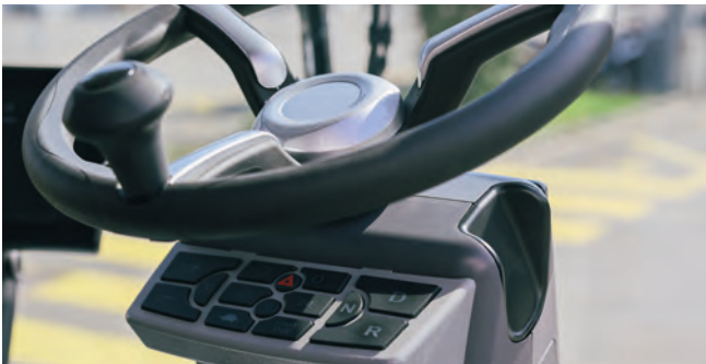
Panneau de commande sur la colonne de direction Le panneau de commande contient tous les boutons nécessaires à la conduite, facilement et rapidement accessibles.
