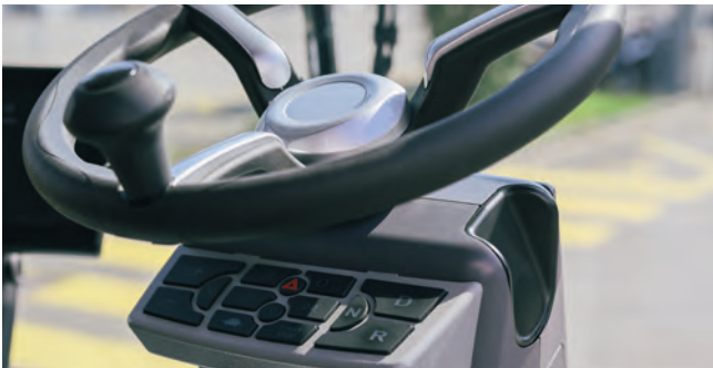
Bedienfeld an der Lenksäule Das Bedienfeld enthält alle fahrrelevanten Tasten, die leicht und schnell zugänglich sind.
