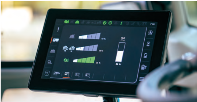
CSense-Display 10,1-Zoll-Touch-Display mit intuitiver Auslegung für erweiterte Funktionen, zentraler Überblick über alle Einstellungen und visuelles Diagnosesystem. Das angezeigte Fahrzeug-Setup ist individuell vom Fahrer wählbar.
