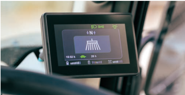
Display conducente Smart-Con Tutte le informazioni rilevanti e i feedback a comparsa in qualsiasi momento grazie al display digitale da 4,3 pollici.
