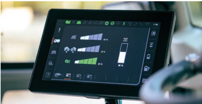
Écran CSense Écran tactile de 10,1 pouces à conception intuitive pour fonctions étendues, vue d'ensemble centralisée de tous les paramètres et du système de diagnostic graphique. La configuration du véhicule affichée peut être sélectionnée par le chauffeur.
