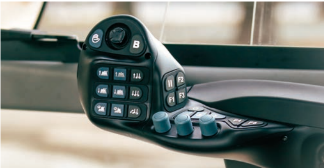
Accoudoir Smart-Con Accoudoir multifonction avec fonction Smart Start permettant d'actionner toutes les fonctions de travail d'une seule main.
