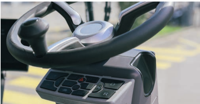
Panel de control en la columna de dirección El panel de control incorpora botones para acceder de forma fácil y rápida a todas las funciones que se necesitan para la conducción.
