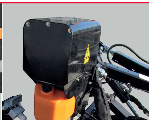
Elektrohydraulisches Aggregat (optional) Ermöglicht den Betrieb des Pfluges auch ohne eigene Bordhydraulik.
