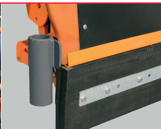
Randsteinabweiser (optional) Der Randsteinabweiser verhindert Beschädigungen am Pflug bei seitlichen Kollisionen.
