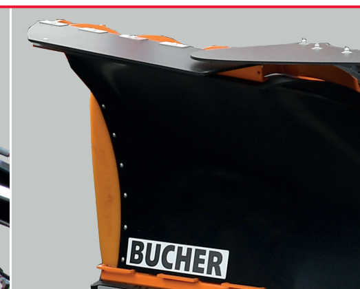
Schneestaubschutz und PU-Kantenschutz Der Schneestaubschutz schützt die Frontscheibe effektiv vor Schneespritzern und hochwirbelndem Schnee. Der PU-Kantenschutz ist ideal zum Räumen an New Jersey Barrieren und dient als zusätzliche Auswurfhilfe.
