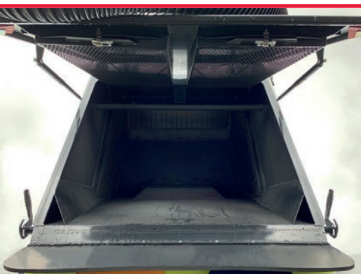
Cuve d'1.8 m³, acier inoxydable
