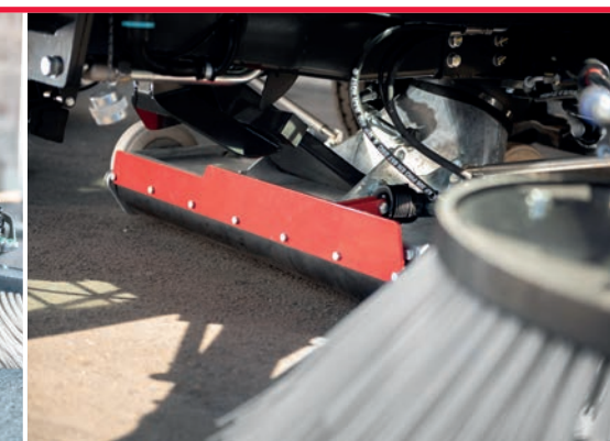
Buse d'aspiration avec clapet amovible
