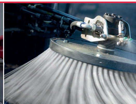
Jets de brumisation pour la liaison des poussières
